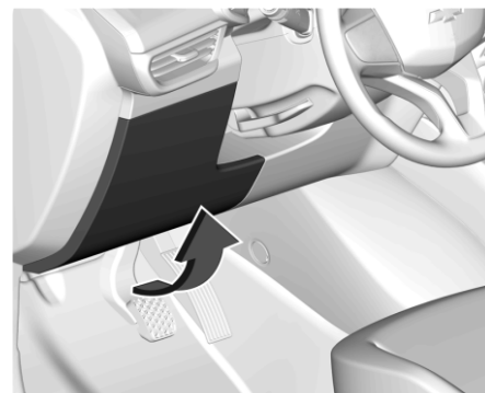
Блок предохранителей в приборной панели
